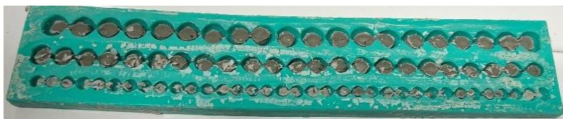
Рис. 1. Внешний вид готового адсорбента для улавливания соединений серы
