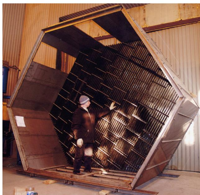
Рис. 12.3. Расположение сепарирующих блоков
