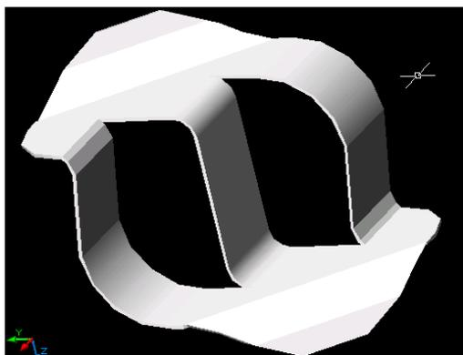
Рис. 8.4. Элемент неупорядоченной насадки «Инжехим-2002»
