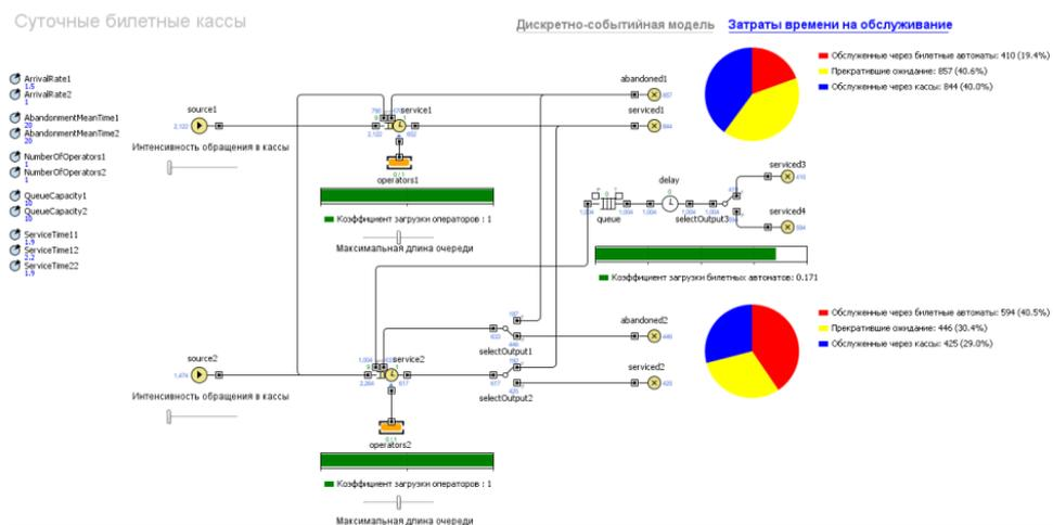
Промоделировать работу технологической цепочки по сборке изделия, состоящего из двух деталей. Первая деталь изделия подвергается двум технологическим операциям до сборки, вторая деталь изделия подвергается одной технологической операции до сборки.
