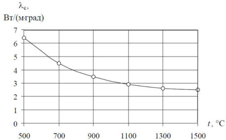
Теплопроводность  $UO_2$  при различных температурах
