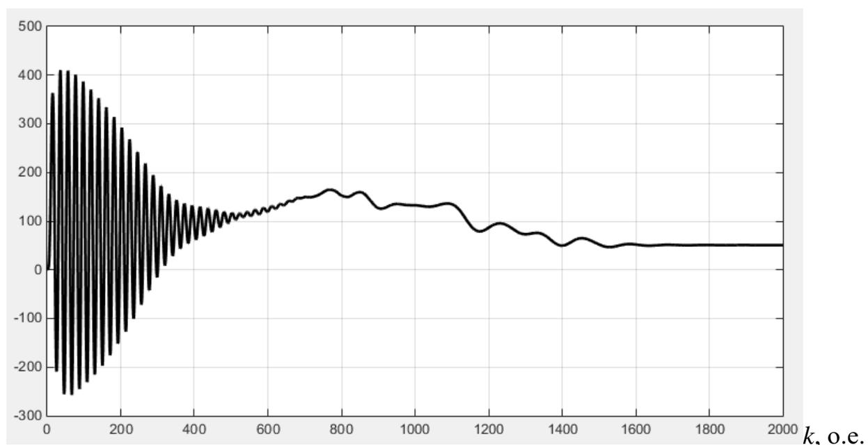
Рис. 2.15. График математического ожидания вращающего момента  $M$
