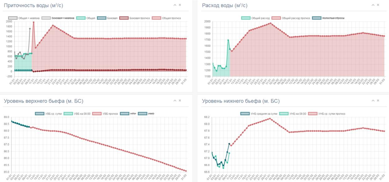
Рисунок 2.19. Результаты расчетов по Воткинскому гидроузлу (требование №1)
