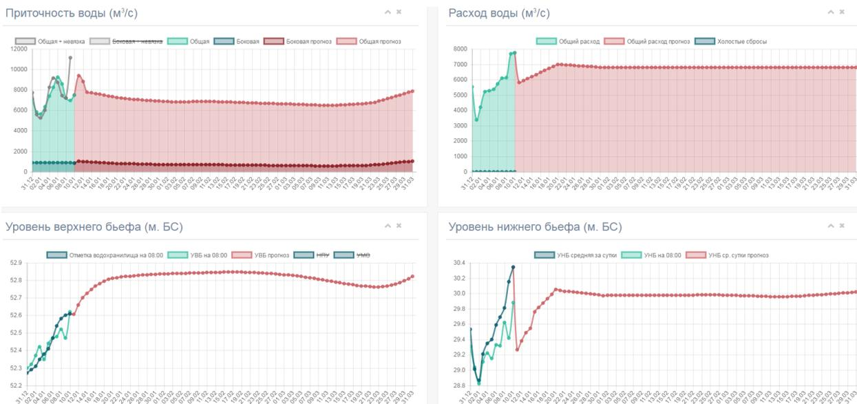
Рисунок 2.23 Результаты расчетов по Жигулевскому гидроузлу (требование №5)
