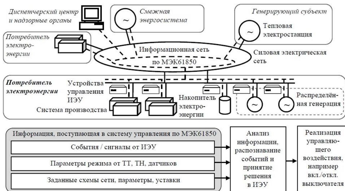
Рис. 2. Общая схема системы автоматического управления электрическими сетями
