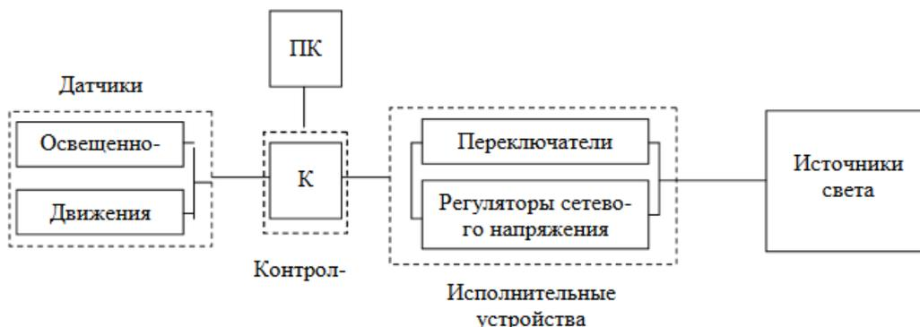
Рис. 1. Структурная схема автоматизированной системы управления внутреннего освещения
