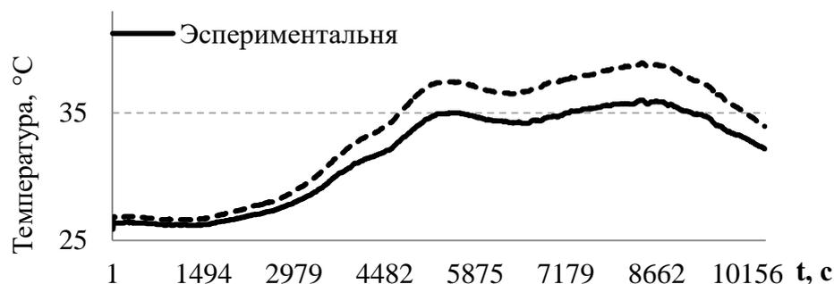
Рис. 4. Экспериментальные и расчетные временные диаграммы температуры кабеля АПв Пу г-1×30/25-10
