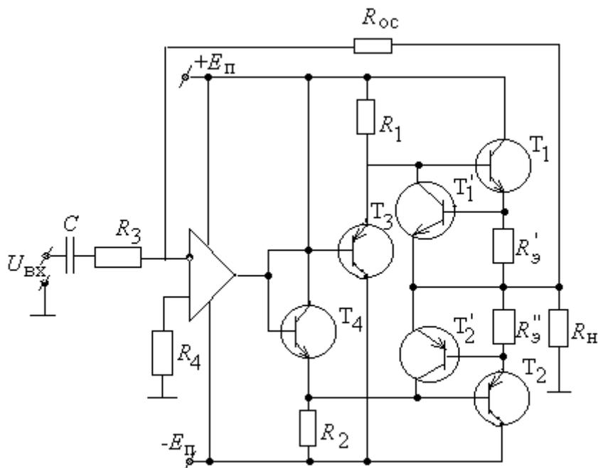
Рис. 2.3. Инвертирующий УМ с токовым бустером, использующим Повторители в целях смещения транзисторов  $T_1, T_2$ .
