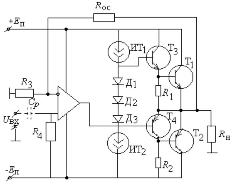
Рис. 2.2. Неинвертирующий УМ с токовым бустером по схеме повторителя с квазикомплементарной симметрией.
