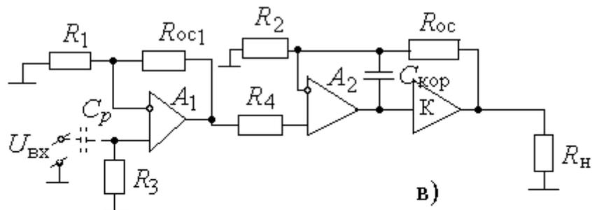
Рис. 1.2. Схема УМ с каскадным включением усилителей на ОУ: *a* – неинвертирующий УМ; *б* – инвертирующий УМ; *в* – неинвертирующий УМ с повышенным  $R_{вх}$ .
