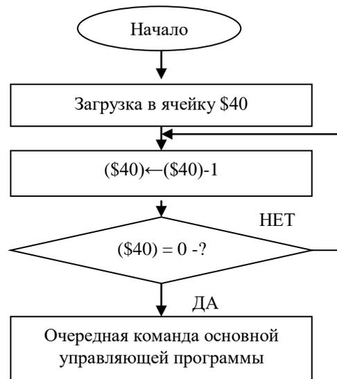
Рисунок 2.10 Блок-схема программы организации временной задержки длительностью 20 мкс программным способом
