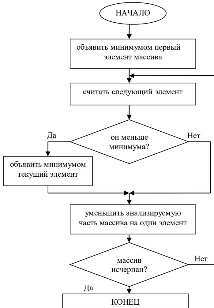
Рисунок 2.1 Блок-схема программы определения минимального элемента массива.
