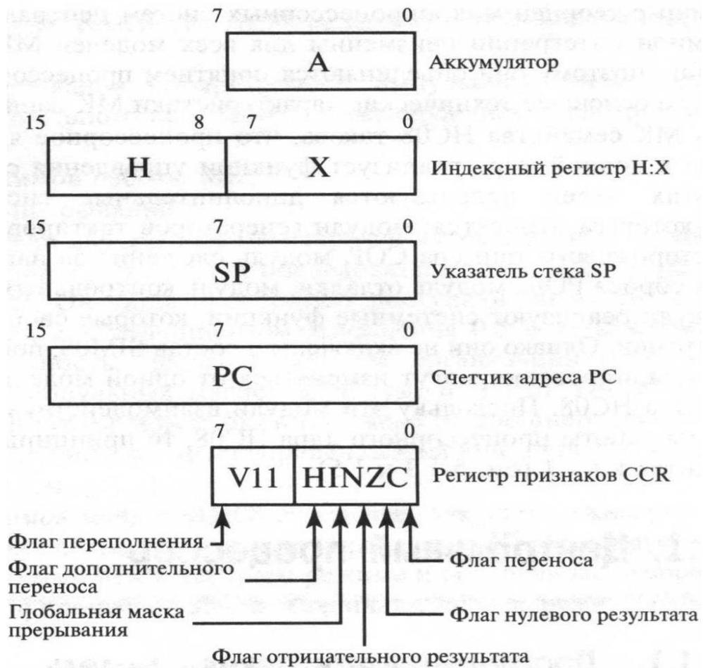
Рисунок 1.5 Программно-логическая модель центрального процессора HC08
