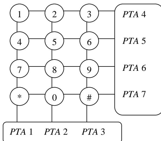
Рисунок 2.5 Схема подключения клавиатуры к выводам *MC68HC908GP32*
