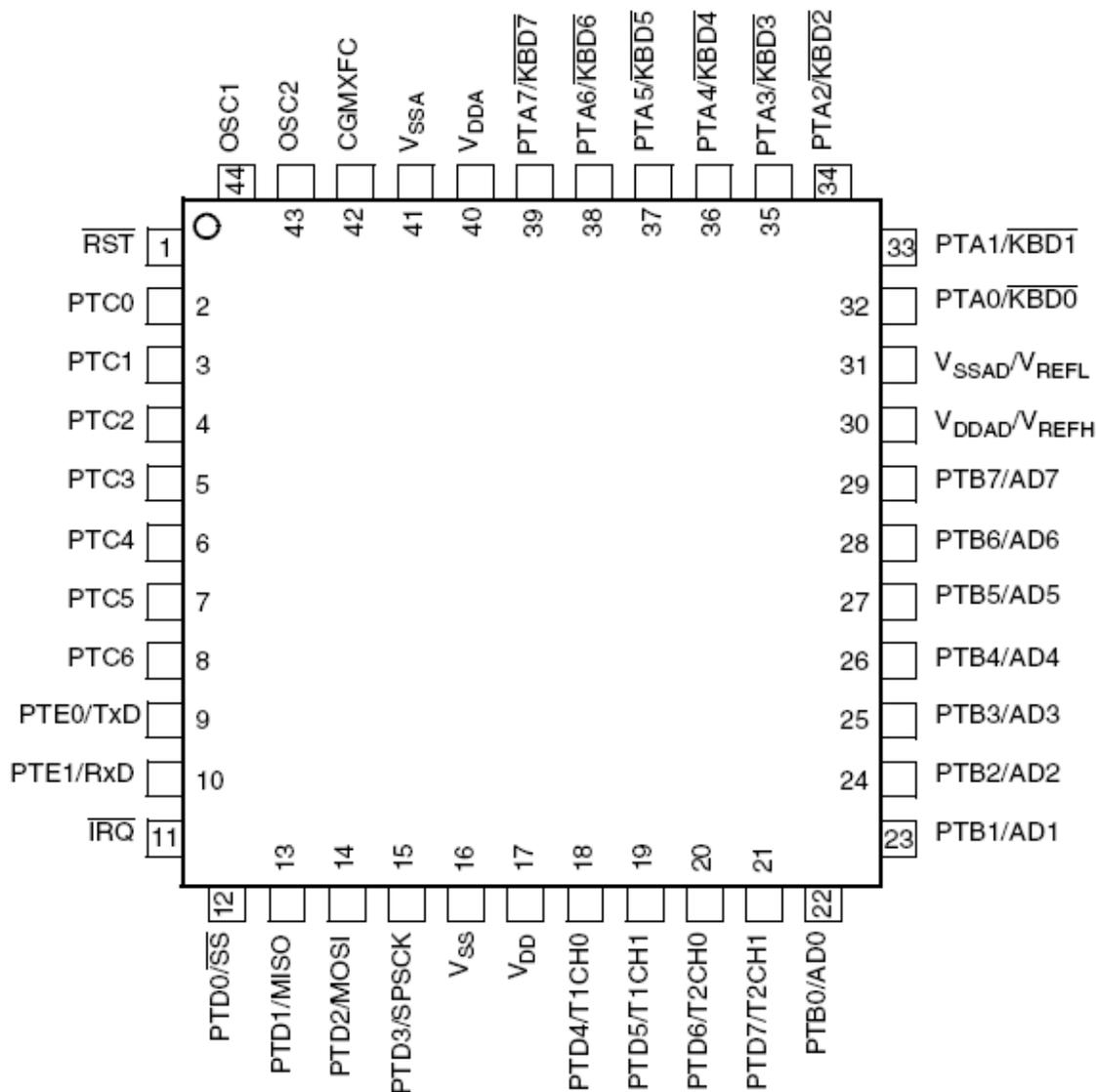
Рисунок 1.3 Вид корпуса и обозначение выводов микроконтроллера *MC68HC908GP32*
