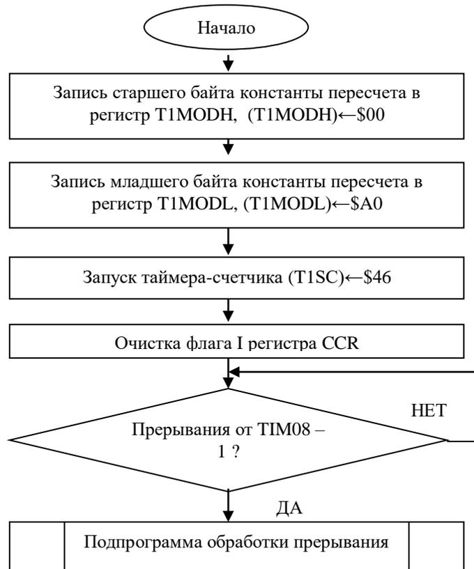
Рисунок 2.9 Блок-схема программы формирования временной задержки 0,5 с
