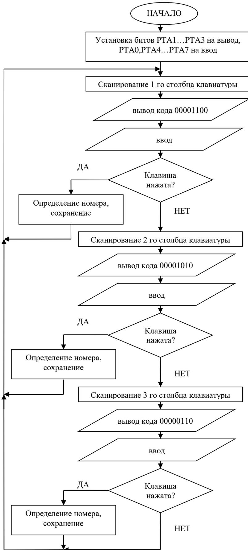
Рисунок 2.6 Блок-схема программы опроса 12-ти кнопочной клавиатуры
