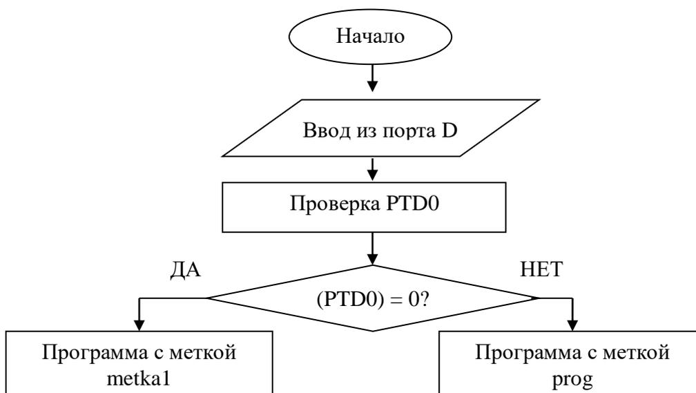
Рисунок 2.3 Блок-схема программы реализации контроля переключения ключа
