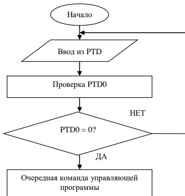
Рисунок 2.4 Блок-схема программы реализации контроля переключения ключа
